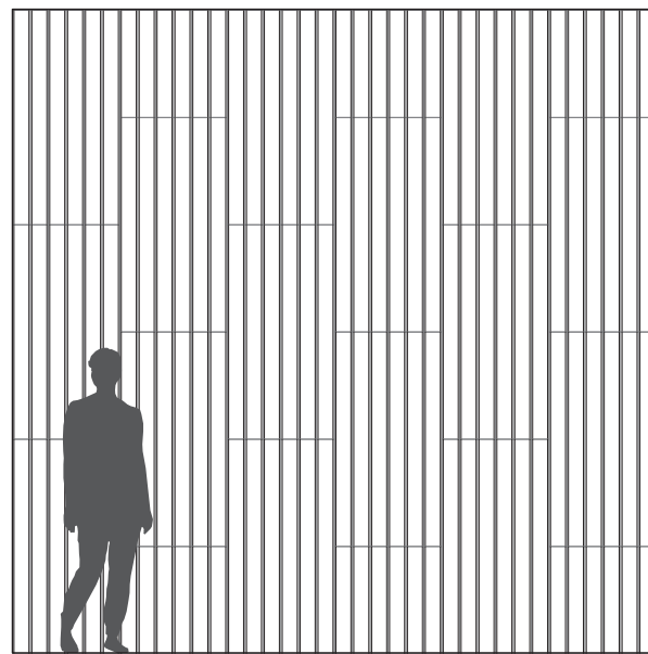
Troldtekt v-line 1way 6 gemonteerd in verticaal halfsteensverband.
