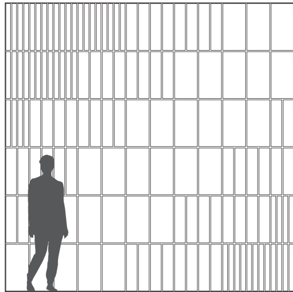
Troldtekt Tiles gemonteerd in alternatief patroon
